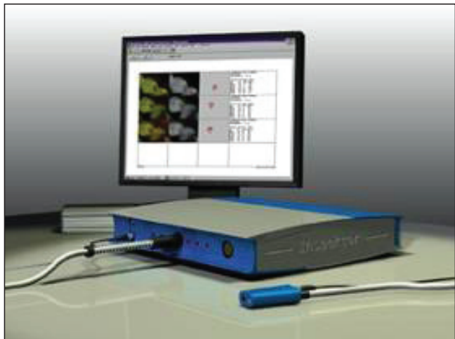
Εικ.13: Συσσκευή QLF-Inspektor (Πηγή εκπομπής του φωτός στο κουτί και η ενδοστοματική κάμερα) αριστερά (πηγή από Pretty 2006/ Caries detection and diagnosis: Novel technologies. Σύνδεση συσκευής με υπολογιστή δεξιά (Πηγή:www.inspektor.nl)
